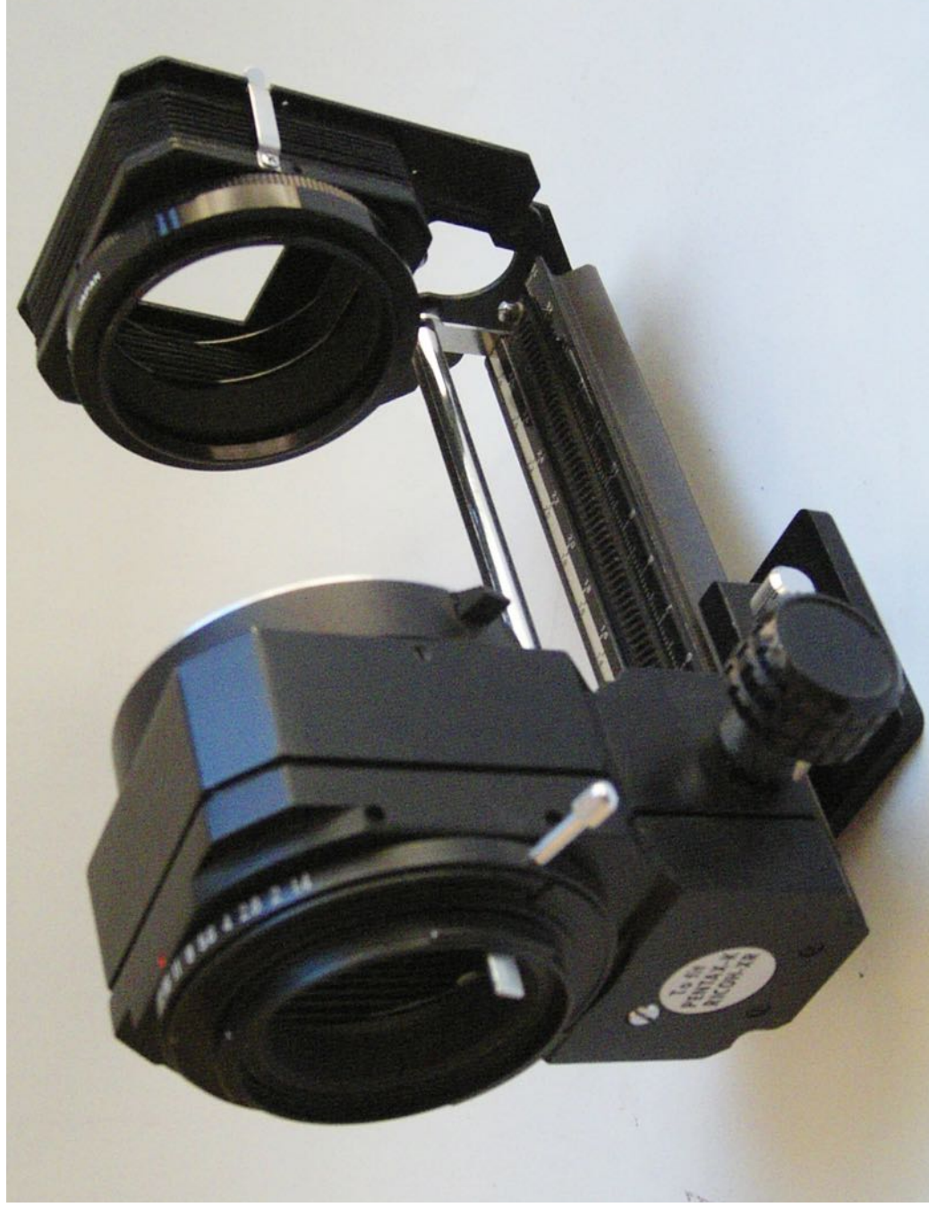
Fig. 31 - Un riproduttore di diapositive Kenlock per Pentax-K e Ricoh-XR. (foto Olivia Musso)
