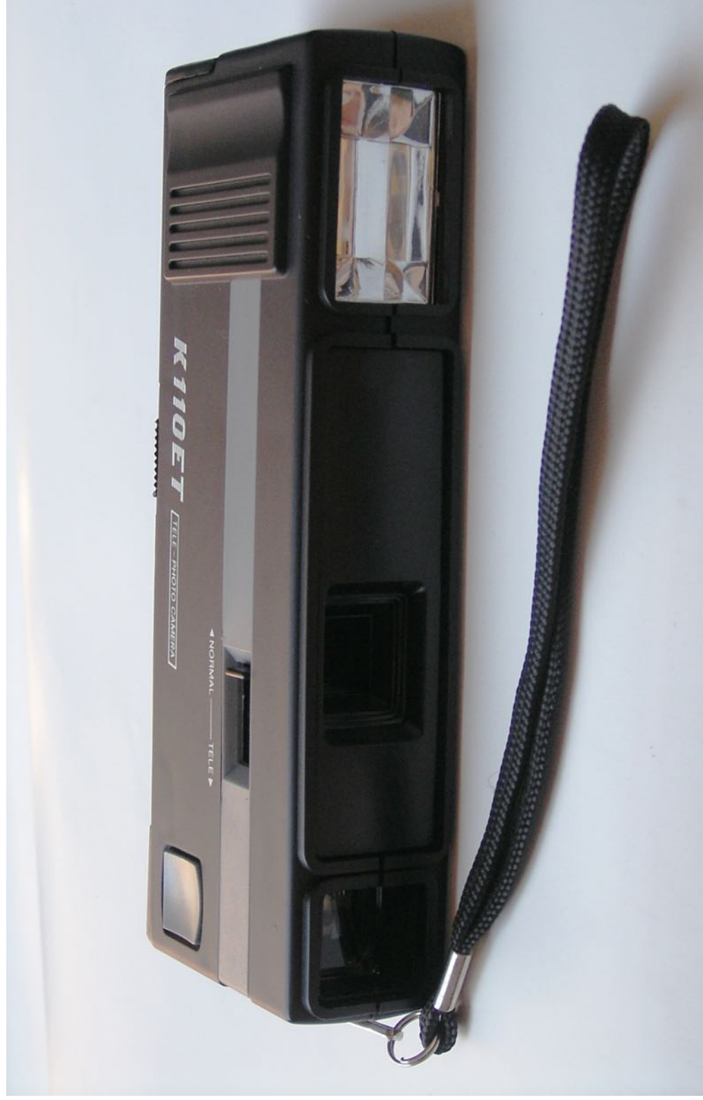
Fig. 16 - Tele-photo camera K110 ET (apparecchio fotografico tascabile con flash incorporato, obiettivo normale e teleobiettivo). (foto Olivia Musso)
