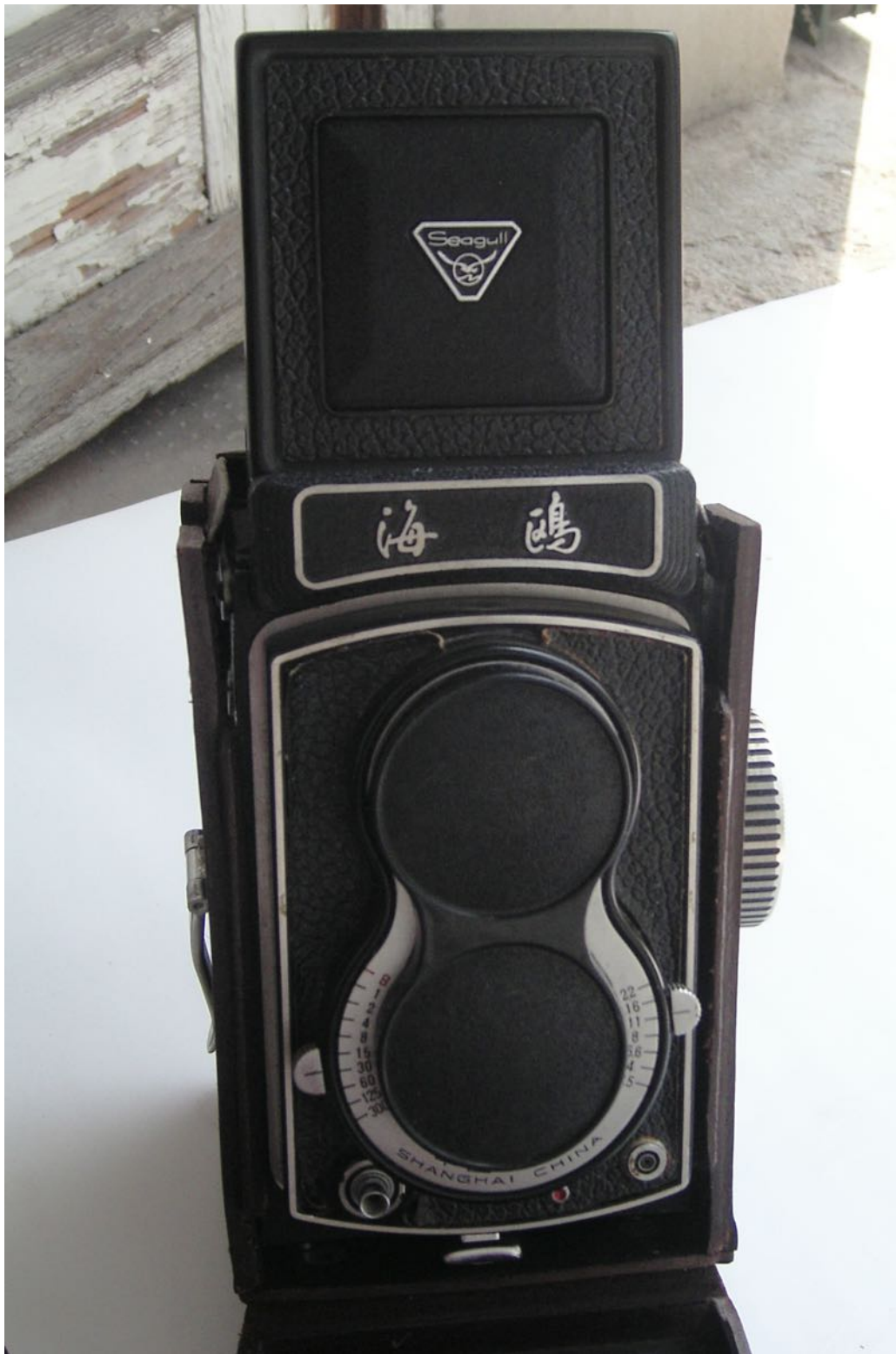
Fig 17 – Apparecchio fotografico Seagull 203 Reflex a imitazione cinese della Rolleiflex con un obiettivo 35/75. (foto Olivia Musso)
